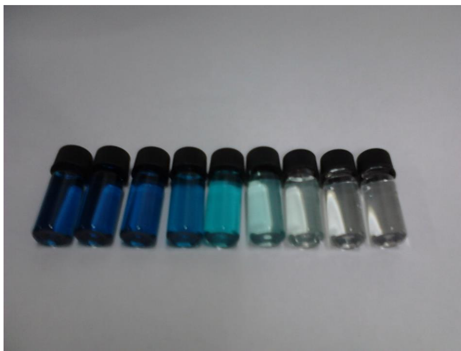
Figura 5.4.2. Imagem das soluções do corante verde brilhante eletrolisadas em meio de K 2 SO 4 (0,1 mol L -1 ) utilizando a densidade de corrente de 100 mA cm -2 e fluxo do eletrólito de 30 l/h em função do tempo de eletrólise.
